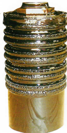
図II. 二次摩耗状態図 (5000~10000km走行時)
